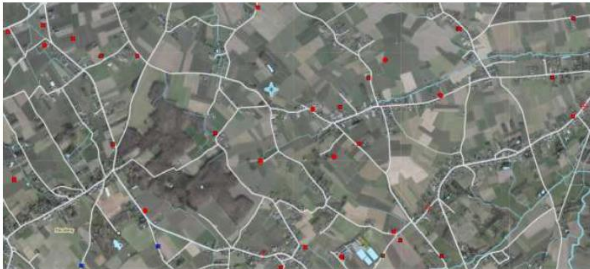
Aanduiding van de gekende ( vergunde ) grondwaterwinningen in de omgeving van de aangevraagde boring
